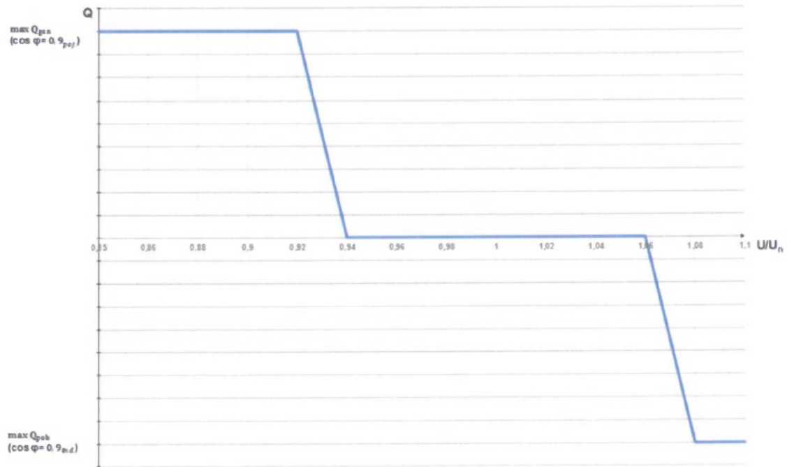
Rys.3. Charakterystyka sterowania mocą bierną w funkcji napięcia wymagana przez APK S.A..
